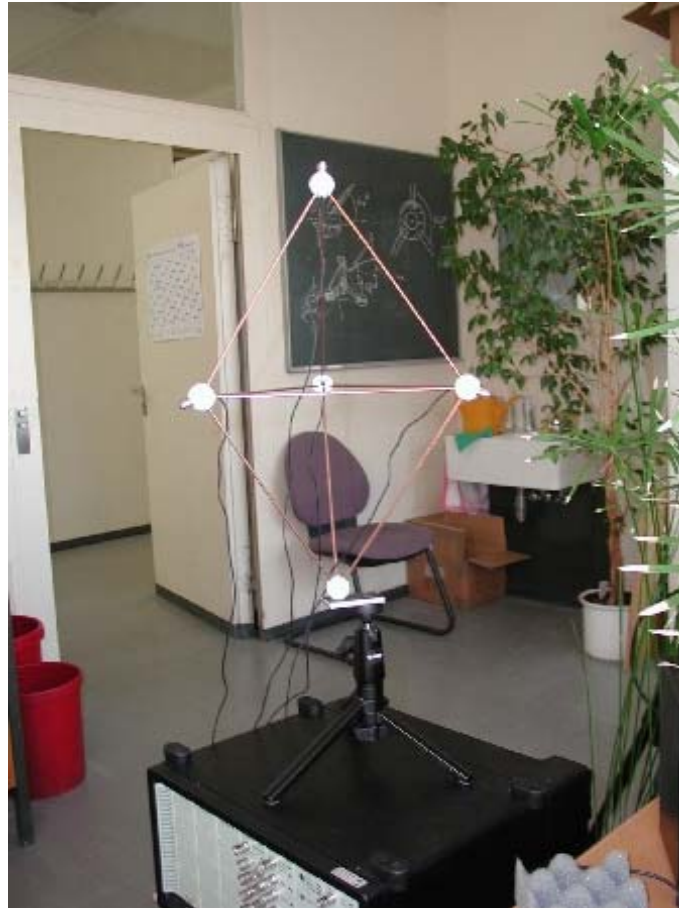
Abbildung 1.2: Versuchsaufbau mit Mikrofonarray
